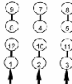
LINE 460 VOLT CONNECTION
